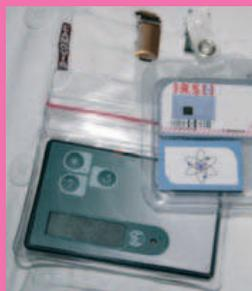
La radioactivité est imperceptible, pour la mesurer il faut des instruments spécialisés. Le dosimètre permet de mesurer le rayonnement auquel un travailleur est soumis.
